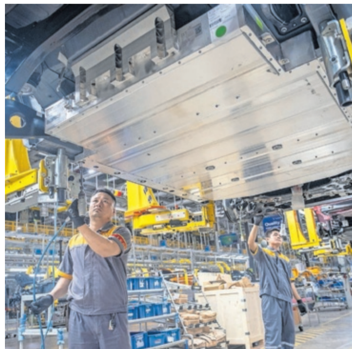
Instalación de una batería en un coche de VinFast. L. P. (BLOOMBERG)
